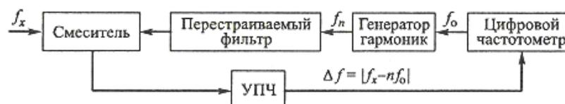
Рисунок 10.15. Структурная схема дискретного гетеродинного преобразователя
