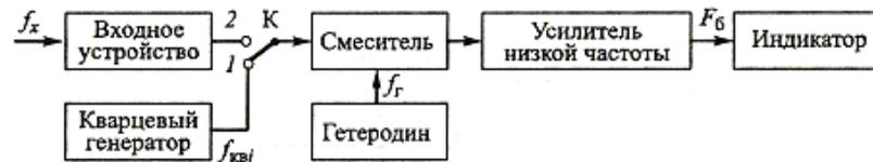
Рисунок 10.14. Упрощенная структурная схема гетеродинного частотомера
