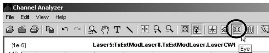
Рисунок 7.2. Включение режима глаз-диаграммы («Eye») анализатора каналов.
