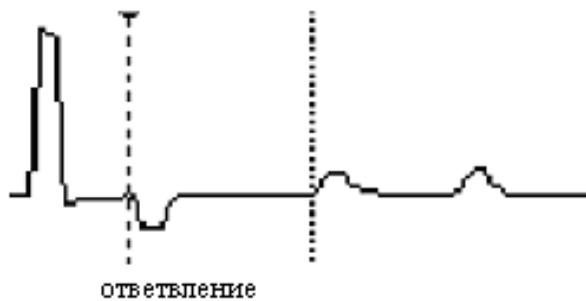
Рисунок 1 (продолжение) – Виды рефлектограмм для типовых повреждений
