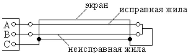
Рисунок 10. Схема для определения расстояния до места повреждения изоляции
