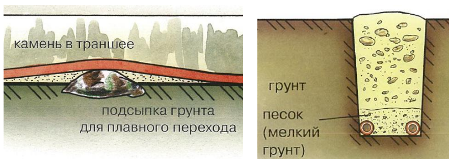
Рис.11. Подсыпка песка или рыхлого грунта на дно траншеи
