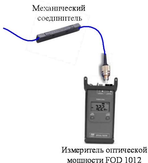
Рис. 3. Схема подключения механического соединителя к источнику излучения
