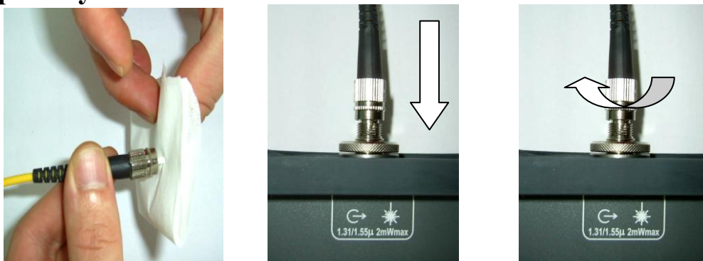
Рис. 1. Этапы подключения разъемов типа FC/PC
