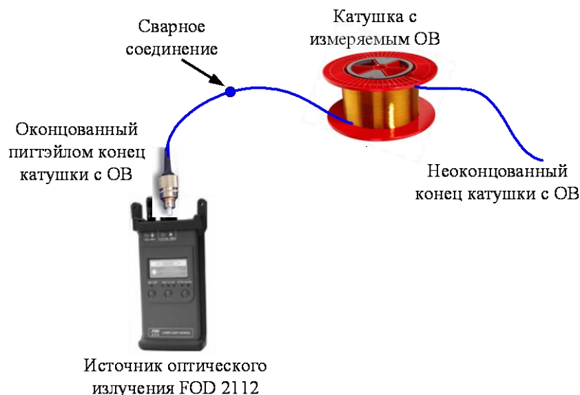
Рис. 2. Схема подключения ОВ к источнику излучения
