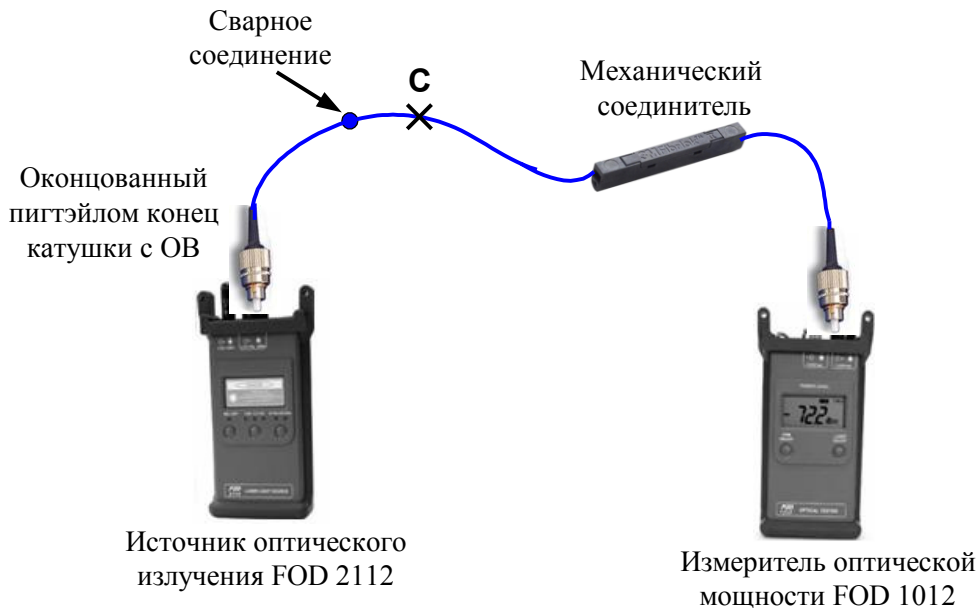
Рис. 5. Схема измерения затухания на выходе “короткого отрезка” ОВ
