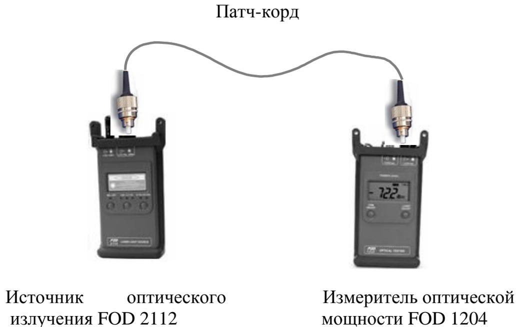
Рис.1 - Схема для определения опорного уровня источника
