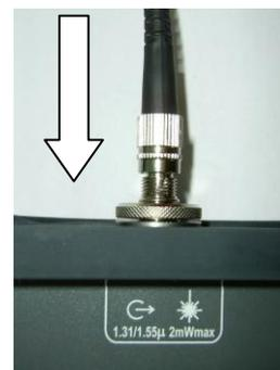
1.3. Зафиксируйте гайку коннектора.
