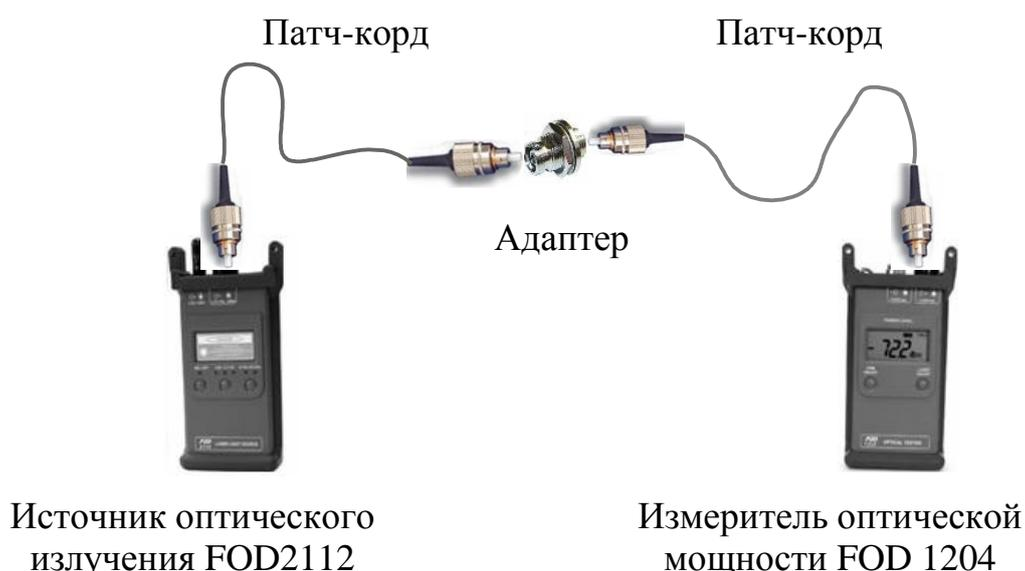
Рис.2 - Схема для контроля качества второго патч-кабеля
