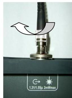
1.4. Аналогично произведите подключение второго конца патч-кабеля к измерителю оптической мощности FOD 1204.
