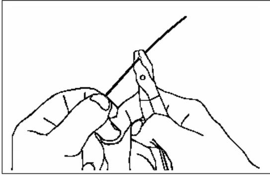
1.2. Установите стриппер под углом около 45 градусов к поверхности волокна так, чтобы при этом, закрыв инструмент, не изогнуть волокно.
