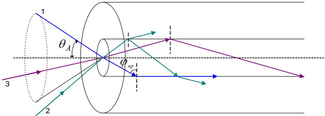
Рис. 4. Связь апертурного угла с углом полного внутреннего отражения
