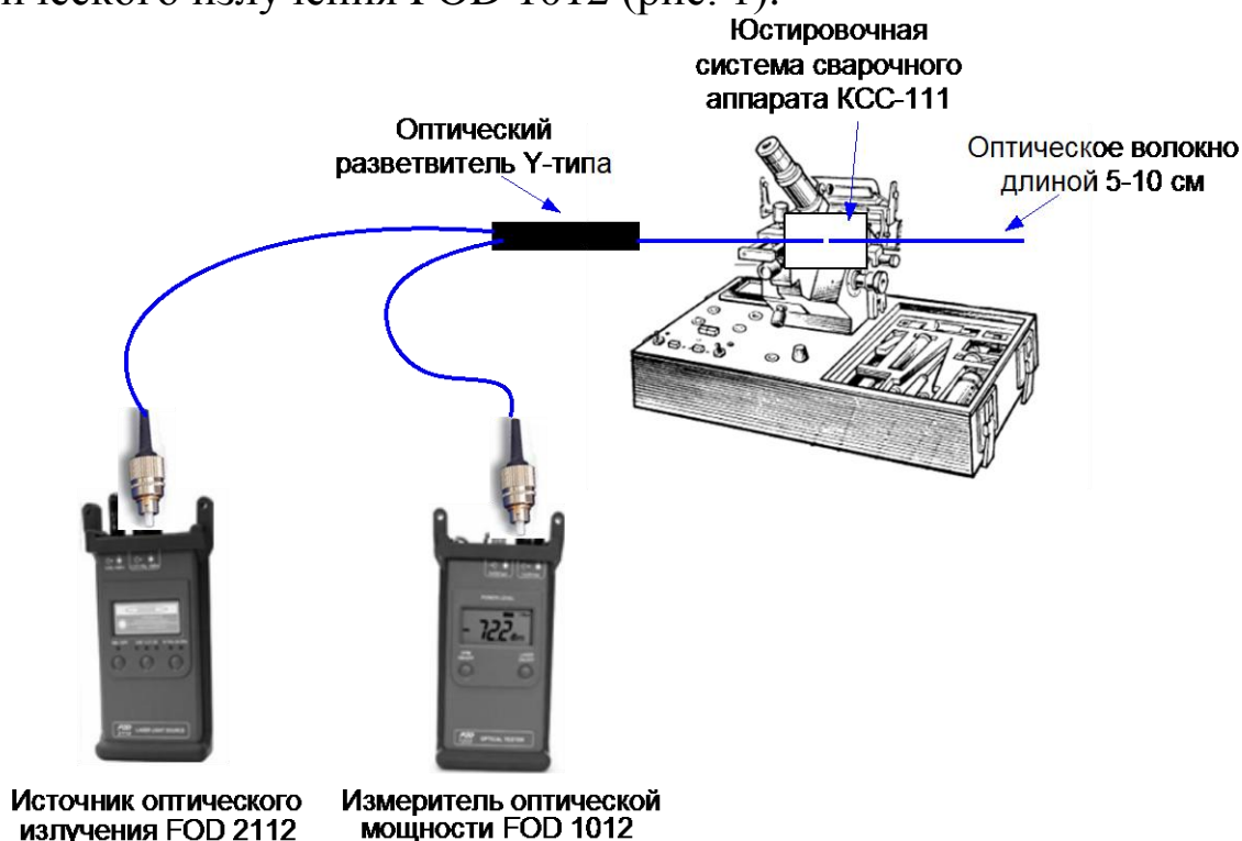
Рис. 1. Схема измерения мощности на выходе волоконно-оптического интерферометра Фабри-Перо
