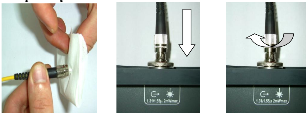
Рис. 2. Этапы подключения разъемов типа FC/PC
